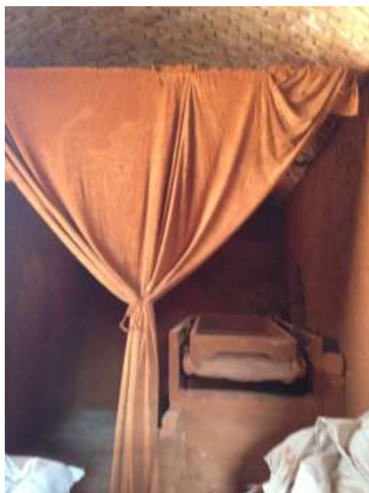
شکل ۲-۸: الک شیبدار موجود در مازاری شهر اردکان جهت صاف نمودن ریشه‌های آسیاب شده.
